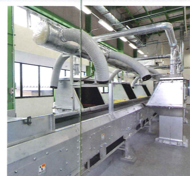
●びん類手選別コンベヤ びんを無色、茶色、その他の色別に選別します。
