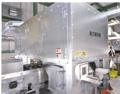
●磁力選別機 磁石の力で、缶・金属類の中から鉄だけを回収します。
