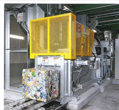
●金属圧縮機 手選別及び機械選別を経て異物を除去された鉄類、アルミ類を圧縮成型します。
