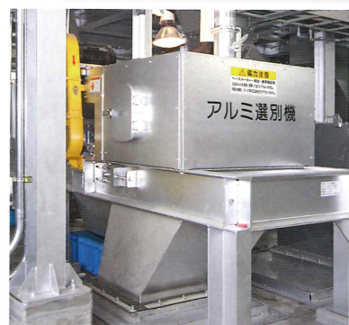
●アルミ選別機 磁石のうず電流の力で、缶・金属類の中からアルミだけを回収します。
