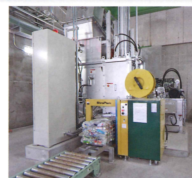
●ペットボトル圧縮梱包装置 手選別台で異物を除去したペットボトルを圧縮梱包します。
